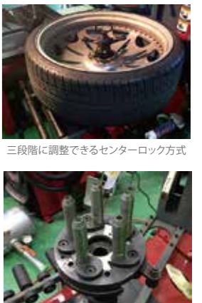
別売品のリバースアダプターを使う事で裏組ホイールにも対応
