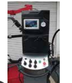
使いやすい操作パネルと目の届かない箇所も確認ができるモニターを装備
