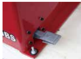
フットブレーキがあることで、ウェイトの位置が決めやすく、作業効率を大幅に向上させる事ができます。
