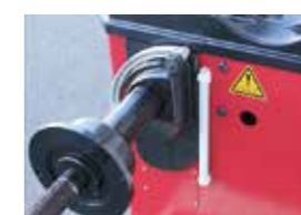
光と音でウェイト位置を知らせる LED 照明付き
