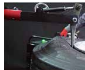
力を使わずに作業を行えるレバーレスタイプ
