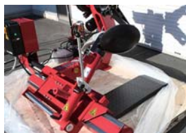
フックとビードブレイカーディスクを使用してタイヤの脱着を行います
