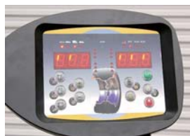
操作性の良いパネルです。モードを切り替える事で乗用車にも対応。高級車の大径リムのバランス測定にも丁度良いサイズ感です。
