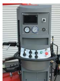
使いやすい操作パネルと 目の届かない箇所も確認 ができるモニターを装備
