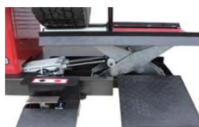
リフターが標準で装備されている為、力を使う事無く大きなタイヤをセットする事が出来ます
