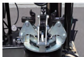
4 段階機構付きの油圧クランプ
