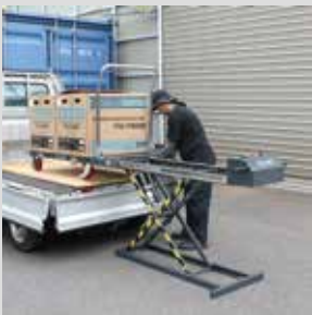
テーブルを荷台へ移動 台座をリフトさせます
