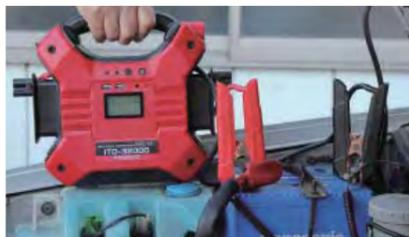
操作は必ずプラス/マイナスクランプを車両のバッテリーに接続してから手順どおりに行ってください。
