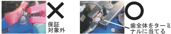
くわえる面積が小さいと発熱し故障します。面積を大きく取り発熱を抑えてください。
